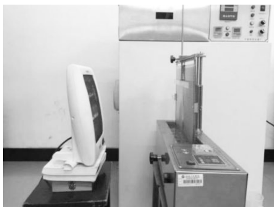
图2 环境温度可控的毛细效应试验装置
