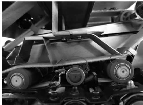
图1 粗纱上清洁绒套与皮辊不接触位置图
