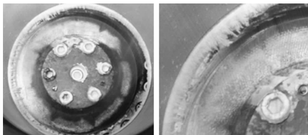
图 11 白色光源采集晶状结块喷丝板图像及细节
