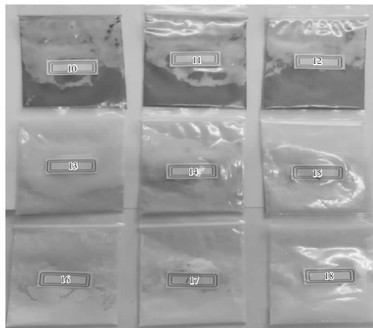
(编号10—12:重铬酸钾/ \beta -环糊精摩尔比为2:1、1:1、1:2所制备包合物粉末;编号13—15:硫酸亚铁/ \beta -环糊精摩尔比为2:1、1:1、1:2所制备包合物粉末;编号16—18:硫酸铜/ \beta -环糊精摩尔比为2:1、1:1、1:2所制备包合物粉末)
